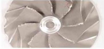
Lovirea rotii **compresor** a fost din cauza intrarii unui corp strain in conducta de aspiratie sau in cuva filtrului de aer. Acest corp putea fi o piulita, un surub, pietricelele si nisipul care se aduna in cuva filtrului de aer sau orice alt corp strain. Va recomandam sa folositi filtre de aer calitative si sa le schimbati la timp. Nu incercati sa indrepatati nici paletetele rotii compresor pentru ca nu are sens. Pieseile oricum nu mai sunt echilibrate.
