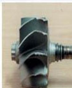
Daca studiem atent **turbosuflanta** observam ca axul a suferit lovituri. Aceste lovituri sunt provocate de un corp strain care putea iesi din motor, cum ar fi: o bucata de supapa, scaune, piston etc. Aceasta se intampla din cauza uzurii motorului. Axul turbosuflantei fiind dezechilibrat duce la imediata uzura a tuturor pieselor din **turbosuflanta**.
