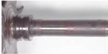
Daca **turbosufianta** are o ungere deficitara uzura pieselor creste foarte repede. In primul rand din cauza fortei de frecare mare, apoi din cauza supraincalzirii pieselor din interiorul turbosufiantei.
